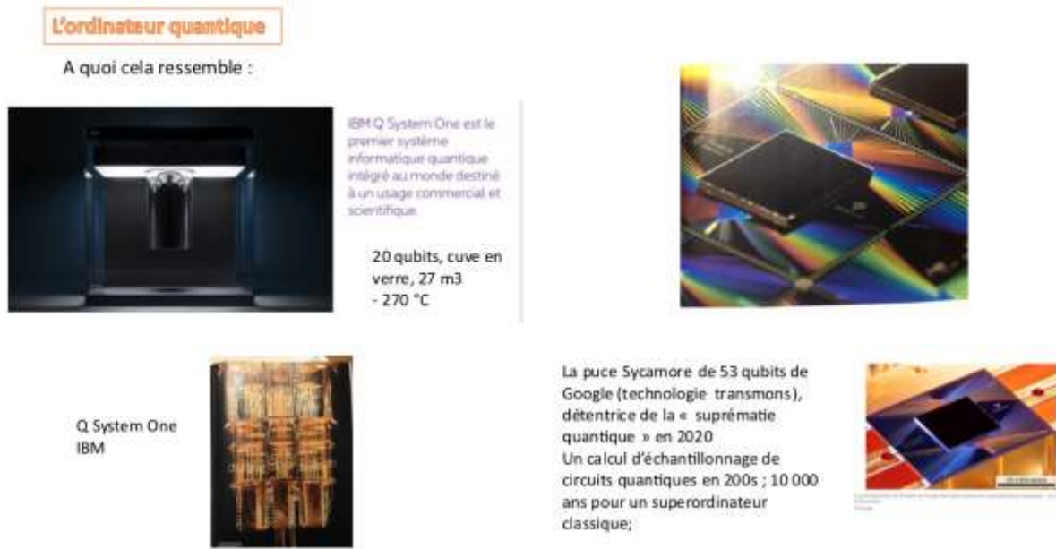
Figure 2 – Premiers ordinateurs quantiques d'IBM (20 qubits) et de Google (53 qubits) en 2020. Technologies supraconducteur nécessitant des températures proches du zéro absolu obtenues par un refroidissement à l'hélium liquide.
