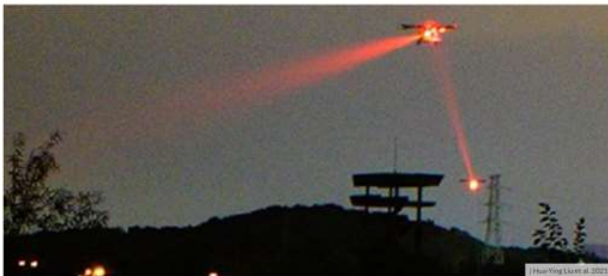
Figure 5 – Liaison optique sécurisée entre deux drones à partir d'une source laser émettant des paires de photons intriqués.
